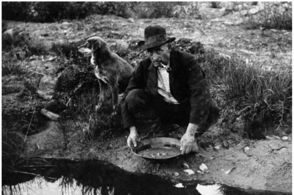
Cercatore d'oro sulle sponde del torrente Orba in una foto dei primi anni del secolo scorso. Si osservi il tipico attrezzo di lavoro: il piatto del cercatore d'oro
